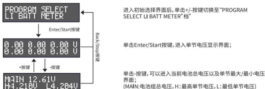
注意: 2~6S LiPo/LiFe/LiHV电池(电池接口与均衡口)连接后可以使用全部功能;
